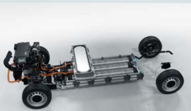
Bauraum passt wie eine vollelektrische Batteriekonfiguration. Das macht es einfacher und kosteneffizienter für die Hersteller, da sie dieselbe Fertigungsplattform für die Montage der Fahrzeuge nutzen können.
