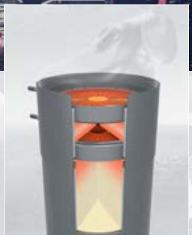
Im Rahmen seines Fokus auf Lösungen für extrem niedrige Emissionen hat Faurecia einen **elektrisch beheizten Katalysator (EHC)** entwickelt, der der Tatsache Rechnung trägt, dass **80 %** der Emissionen unter realen Fahrbedingungen beim Kaltstart entstehen.
