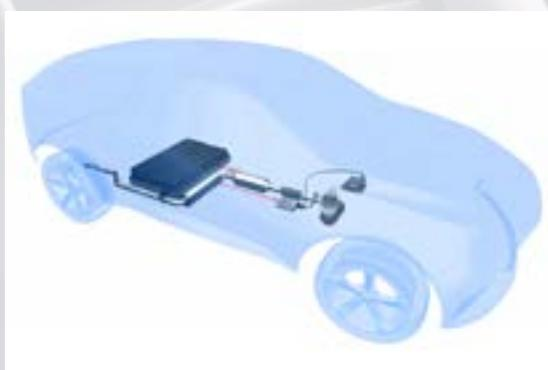
Der EHC wird in Niedrigtemperaturphasen aktiviert und nutzt elektrische Energie, die in Wärmeenergie umgewandelt wird, um die Abgase und die keramischen Katalysatorzellen mit Hilfe einer geschützten Technologie mit sehr geringer thermischer Trägheit zu erhitzen. Der EHC ermöglicht es den Katalysatorzellen, ihre volle Effizienztemperatur in kürzester Zeit (weniger als 10 Sekunden) zu erreichen.
